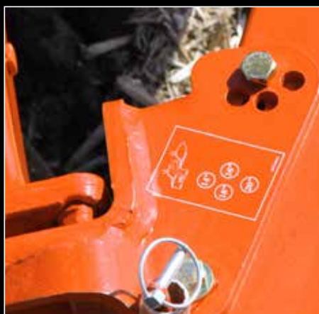
Ajustement manuel de la largeur de travail. Simple repositionnement d'un boulon (modèles RM2000-RM2005)
