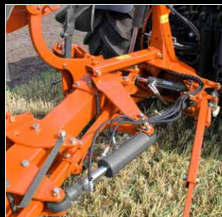
Varilarge®. Parallélogramme avec vérin de remise en ligne et ajustement hydraulique du 1 er corps (RM2000V-RM2005V)
