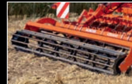
Double rouleau cage ø400 mm
