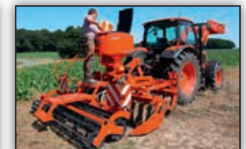
Le châssis peut supporter les SH de 200l ou 500l.
