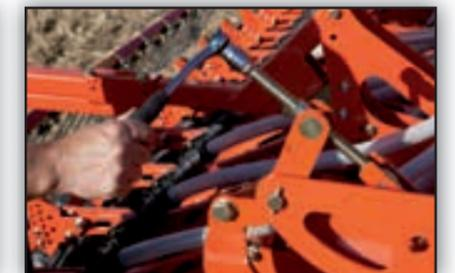
Réglage centralisé du terrage des éléments semeurs (hydraulique en option).
