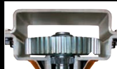
Colonne vertébrale de ces 5 modèles, le caisson est constitué de 2 demi-couvercles boulonnés de 125 X 400 mm pour la 1000, de 140 X 400 mm pour la 2000 et de 150 X 400 mm pour la 3000.
