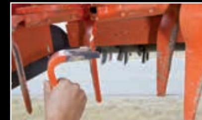
Les dents à démontage rapide sont fixées grâce à un axe et une goupille totalement intégrés dans le portedents.
