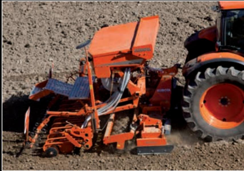
Disponible en 3m, 3.5m et 4m, le semoir Kubota SD2000M dispose d'un châssis renforcé afin d'accroître les performances du semis en combiné. La barre de semis à double poutre très stable peut répondre à toutes les utilisations ; du semis sur labour au semis en techniques culturales simplifiées.
