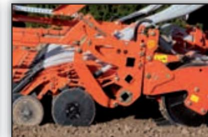
Système de suivi automatique de la barre de semis au rouleau de la herse rotative.
