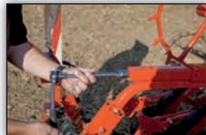
Herse de recouvrement à dents en S Ø 10 mm avec réglage de pression et d'angle d'inclinaison.
