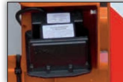
Un radar peut remplacer la roue squelette lorsque l'on est avec l'entraînement électrique de la distribution
