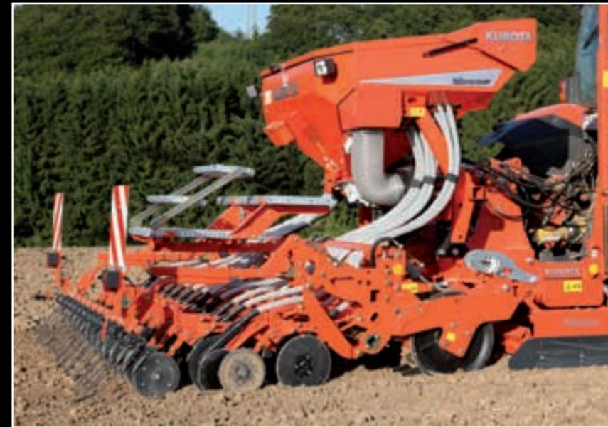
Le semoir Kubota SD2000MP reprend la même conception que le SD2000 avec en plus la particularité d'être totalement intégré. La barre de semis est en liaison directe avec le châssis du rouleau de la herse rotative.
