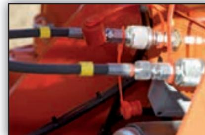
Connexion centralisée des branchements électriques et hydrauliques sur l'attelage de la herse rotative.
