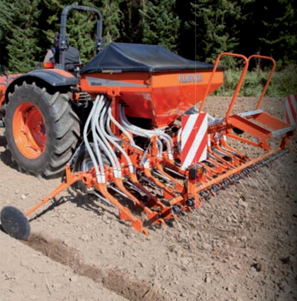
Le SD1000, disponible en 3m, 4m et 4,5m, est doté d'une trémie de 750 l qui peut-être portée à 1000 l. En dimension standard ou en basse pression, les roues sont dans la voie du tracteur grâce à la voie réglable (de 1.65m à 2.10m). Le transport sur route du SD1000 se fait facilement que ce soit sur un 3m mais également sur un 4m ou 4,5m grâce aux extensions repliables manuellement.
