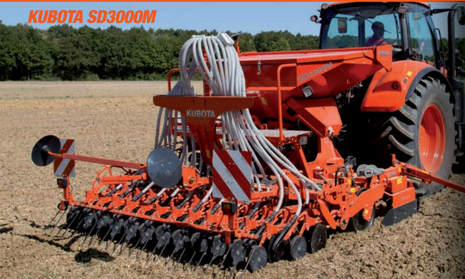
La SD3000M a été conçue afin d'obtenir une intégration parfaite du semoir sur les herse rotatives Kubota en offrant de nombreux avantages pour l'utilisateur: grande capacité de trémie, centre de gravité proche des bras d'attelage du tracteur ce qui diminue la capacité de relevage nécessaire, polyvalence grâce au système de fixation rapide de la barre de semis sur le châssis du rouleau arrière pour une utilisation de la herse rotative en solo.
