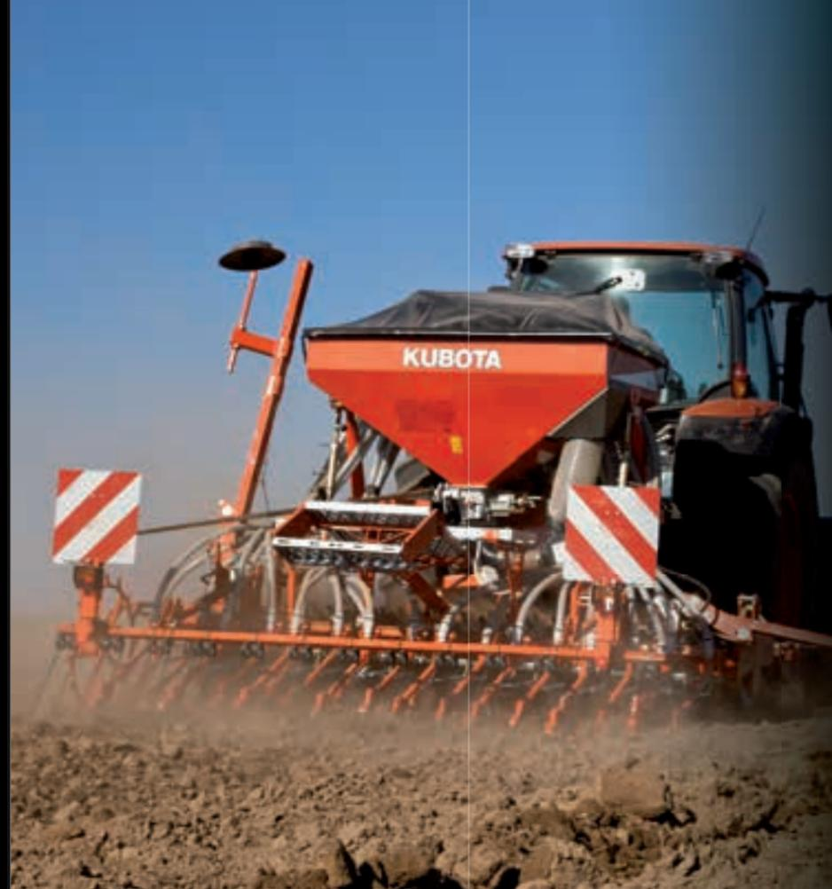
Les semoirs SD1000M, disponibles en 2.5 et 3m, sont intégrés par l'intermédiaire d'un triangle d'attelage fixé sur l'outil. La forme de la trémie de 750 L est telle que le volume résiduel est pratiquement nul. La barre de semis, fixée au châssis du semoir par des parallélogrammes, est réglable en hauteur par des chandelles.
