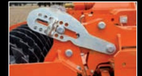
Le système de réglages par parallélogramme, en standard sur les herSES 2000 et 3000, permet d'ajuster la profondeur de travail par palier de 2,5cm. Ce système à broches est très accessible de chaque côté de la machine.
