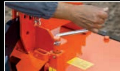
La planche niveleuse à réglage par manivelle graduée et sécurité à ressort assure un meilleur émiettement et nivellement.
