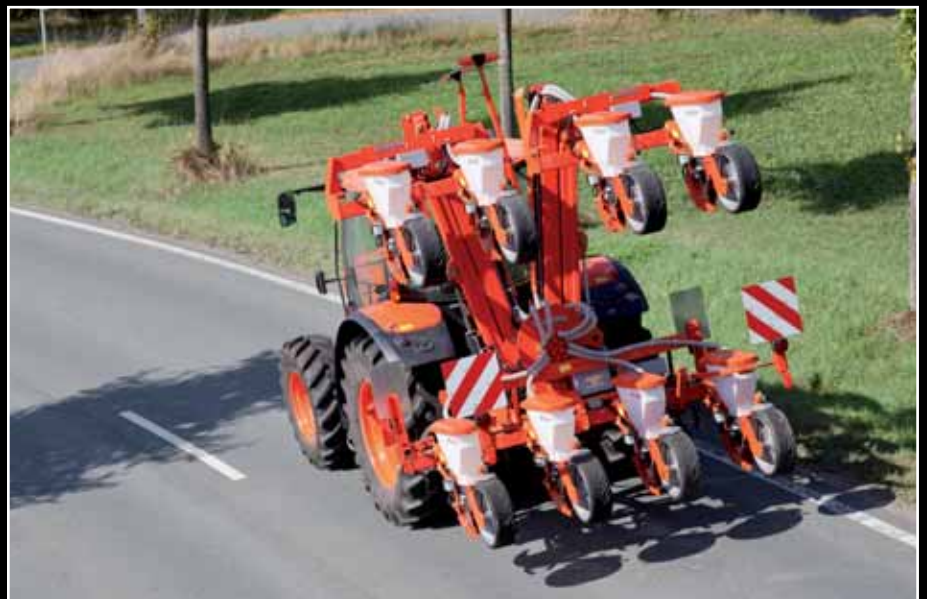
Châssis 6.00m repliable au transport (<3m)
