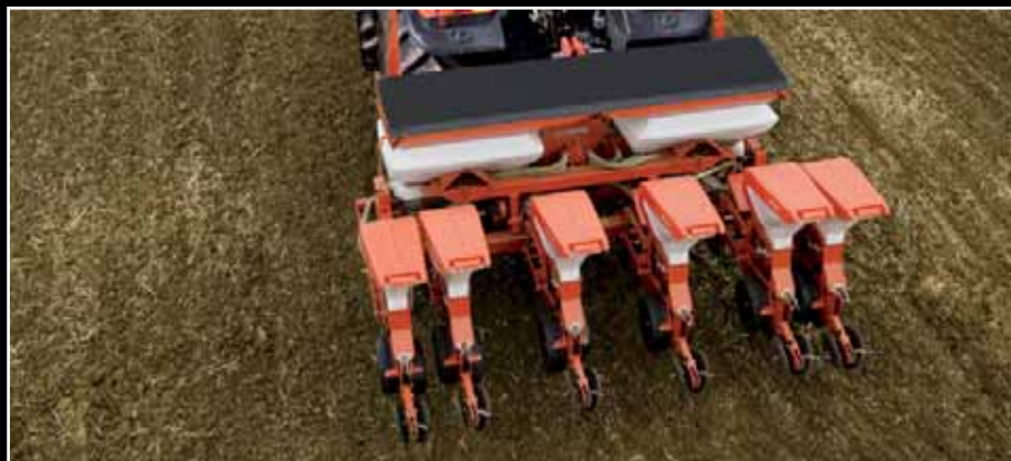
6 rangs télescopique, largeur de travail 4.00 m, avec fertiliseur de 770 litres
