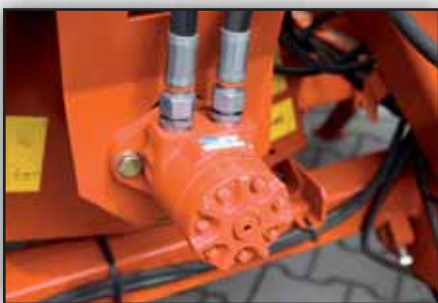
Entraînement hydraulique de la soufflerie
