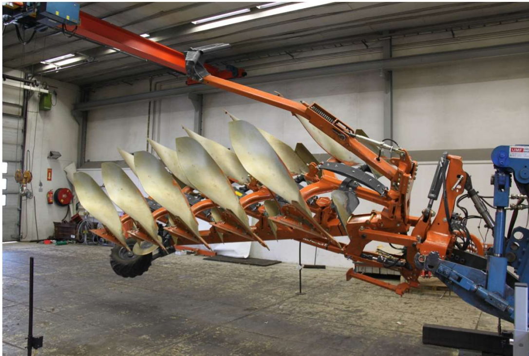
Tests de retournement et de simulation transport
