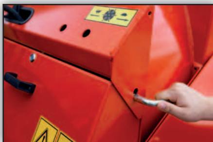
Boîte à 2 vitesses pour le paillage et la distribution.
