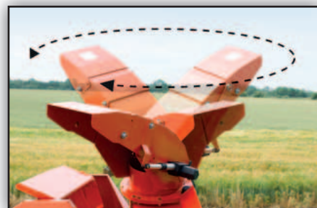
La goulotte pivotante assure une rotation de 260°.
